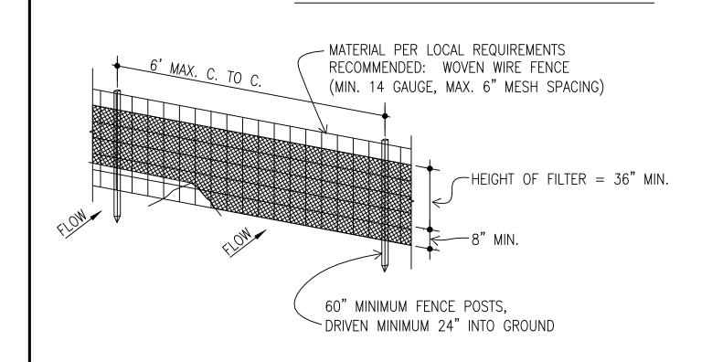
7 SILT FENCE EROSION PROTECTION
